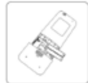
Ersetzen Sie die Batterien.
